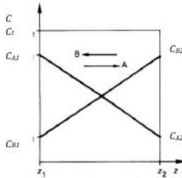
**Figure** . Profil de la concentration pour le cas de la contre diffusion équimolaire des gaz A et B.
