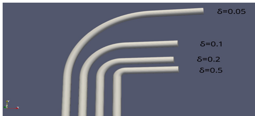
Figure III.1- Géométries pour Re = 100 avec «FreeCAD».
