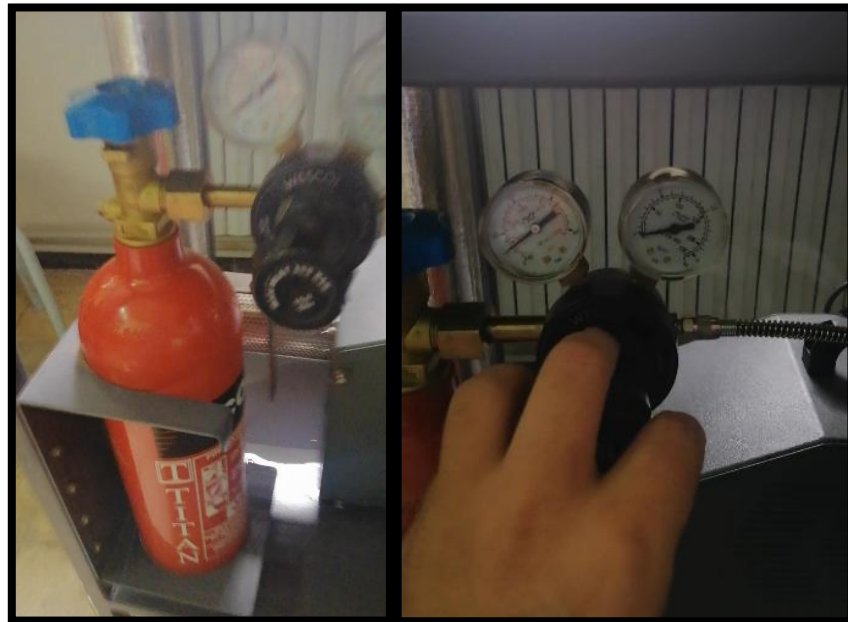
Figure A.6: le fiole des gaze CO_2 et le vise de réglage sont pression et les conteurs de mesure .
