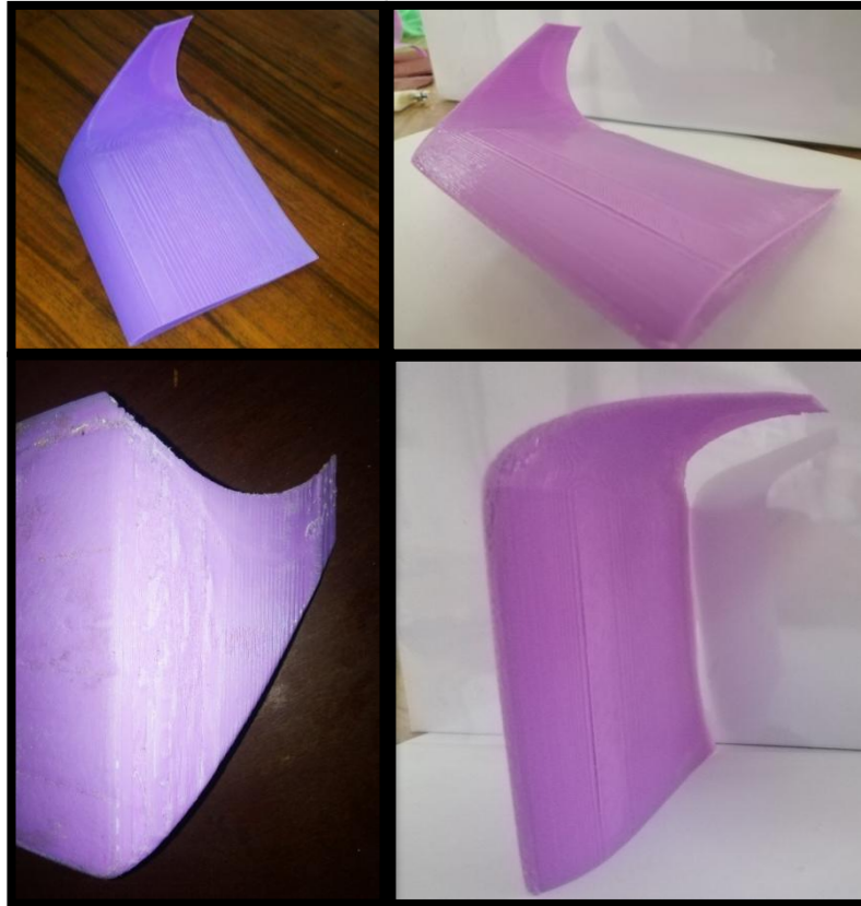
Figure III.24: le type de winglet trapézoïdale qui imprimé .
