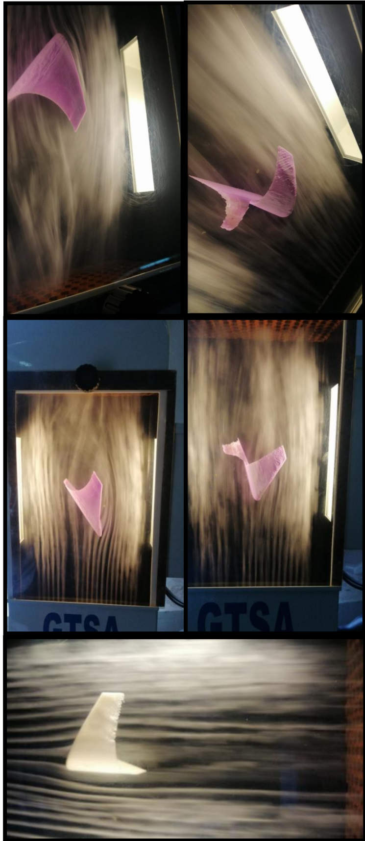
Figure A.7: les modèle des winglets en le banc d'essai pondent l'expérience .
