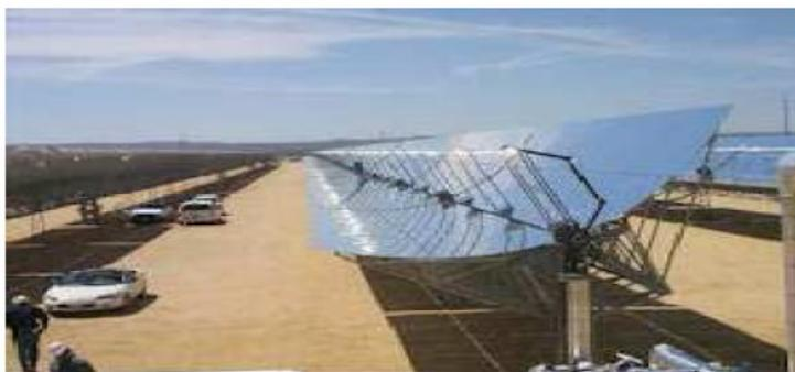
**Figure I-5:** Concentrateur cylindro- parabolique
