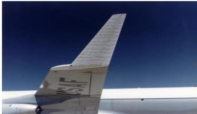
Figure 1.1: Winglet montée sur le KC-135 pour les essais de la NASA. NASA photo EC79-11481.
