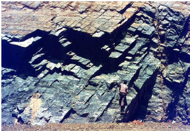
Exemple de joints observés (un ensemble dominant)
