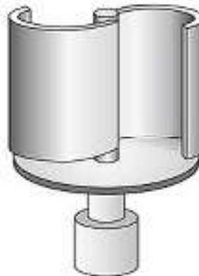
**Fig. 1.7** Turbine Savonius
