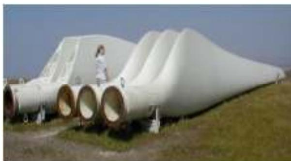
**Fig. 1.12** Pales mesurant environ 15 m de long
