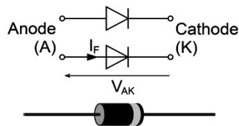
Lorsque le courant va de l'anode vers la cathode, c'est le sens passant. La diode se comporte idéalement comme un fil. Dans le sens inverse, c'est un interrupteur ouvert. Ce dipôle est appelé diode de redressement lorsqu'il est utilisé pour réaliser les redresseurs qui permettent de transformer le courant alternatif en courant unidirectionnel.
