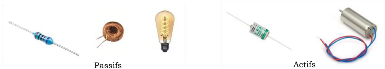
Figure I.2. Dipôles passifs et actifs
