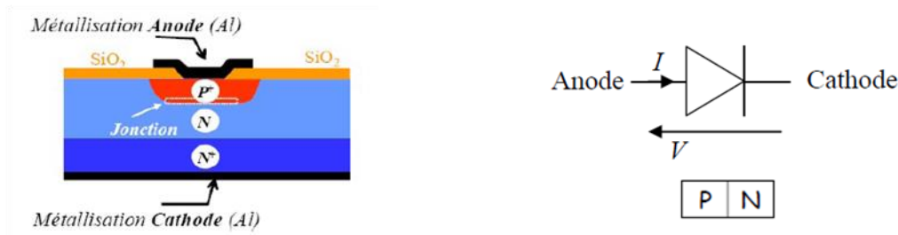
Figure II.8 Diode à Jonction PN et son symbole
