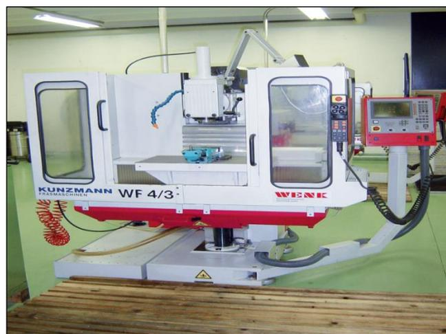
**Figure I.1** : Machine à commande numérique.
