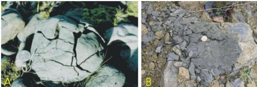
A: cryoclastie d'un basalte (roche macro-gélive) B: cryoclastie d'un schiste (roche micro-gélive)
