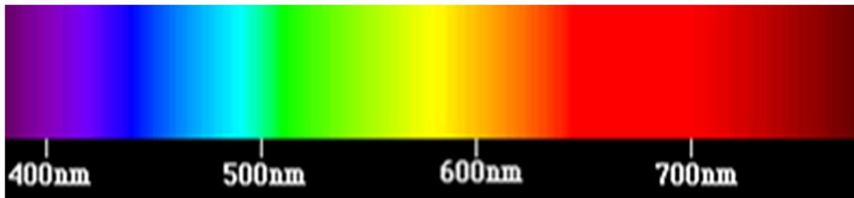
Les capteurs utilisés en télédétection peuvent capter l'énergie provenant de différentes fenêtres spectrales à l'intérieur même du visible (le satellite SPOT par exemple, est sensible au rouge et au vert, le satellite américain IKONOS lui, dispose de trois bandes spectrales dans le visible, sensibles au rouge, au vert et au bleu).
