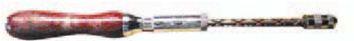
**Tournevis automatique :** la translation de l'écrou mène la rotation de la vis et inversement.
