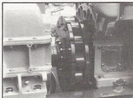
Accouplement «Radiaflex RTP4-12» entre moteur marin MGO - 12 cylindres et inverseur de marche.
