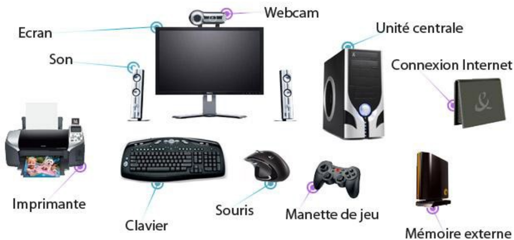
Figure 1. Un ordinateur et ses différents périphériques
