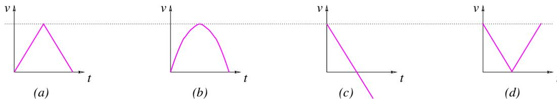
Solution : Une fois lancée (avec une vitesse initiale  $v_0$ ), la vitesse de la bille s'écrit :  $v(t) = -gt + v_0$ . Si on dessine la courbe  $v(t)$  on obtiendra quelque chose de similaire au graphe (c). Le graphe (c) est donc celui qui représente le mieux la courbe de variation de  $v(t)$ .
