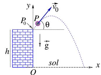
Solution : a) Par rapport au point de lancement  $P_0$ , la position du projectile  $P$  est donnée par  $\vec{P_0P}$ . Si on néglige la résistance de l'air, le projectile, une fois lancé, n'est soumis qu'à l'accélération  $\vec{g}$  de la pesanteur. Donc  $\vec{a} = \vec{g}$ . Il s'ensuit que
