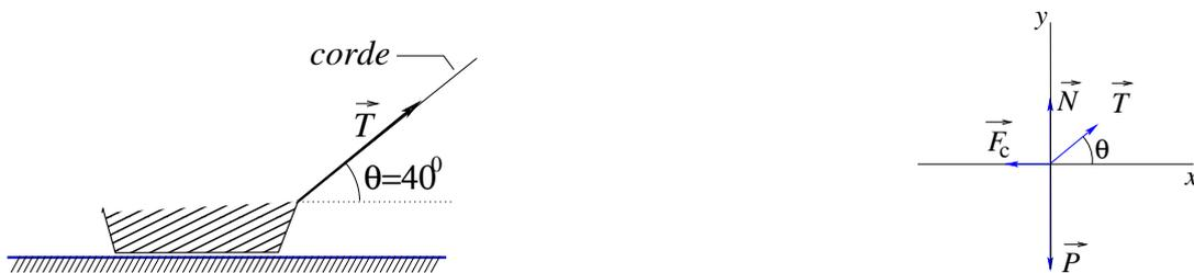
**SOLUTION :** Les forces agissant sur le traîneau sont (figure de droite ci-dessus) : son poids  $\vec{P}$ , la traction  $\vec{T}$ , la force de frottement cinétique  $\vec{F}_c$  et la force normale exercée par le plan. Le traîneau n'étant pas accéléré,
