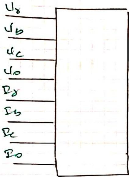
c'est à dire les trois tensions et les trois courants ( $U_a, U_b, U_c, I_a, I_b, I_c$ ) la tension et le courant résiduel ( $U_o, I_o$ ) et cela à titre de contrôle,
