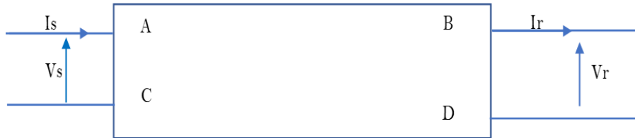
Figure 5.1 : Représentation d'un réseau électrique en quadripôles.
