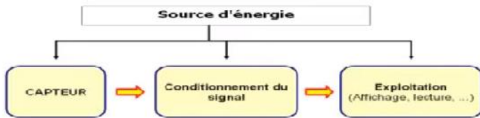
Figure01 : Schéma Synoptique de la Chaîne de mesure
