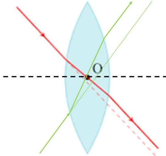
Fig. 5-3 : le point O est le centre optique de cette lentille.
