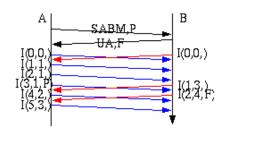
L'exemple suivant, illustre un cas d'échange unidirectionnel avec perte de trames.
