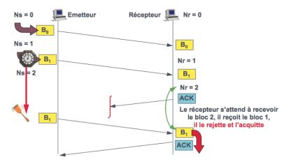
Dans les cas où les délais de consommation sont plus importants, les données peuvent ne pas être acquittées à temps. Par exemple, si A transmet un bloc B0 et B se tarde dans son traitement, A va retransmettre B0 avant de recevoir l'acquittement. Si A transmet un nouveau bloc B1 et se perd, il va considérer l'acquittement du deuxième B0 comme un acquittement de B1.
