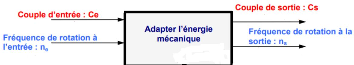
Les boîtes de vitesses sont des composants mécaniques essentiels à tout mécanisme. Ils permettent la transmission de mouvement et de puissance. La particularité d'un réducteur est qu'il réduit la fréquence de rotation ( $n$ ) mais augmente dans les mêmes proportions le couple.
