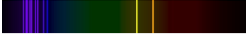
Spectre de la lumière émise par une lampe à vapeur de sodium
