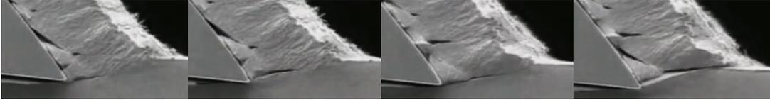
Le copeau idéal est de forme longue et en spirale (tirebouchon). Cette forme est due à la différence de tension qui existe entre la surface extérieure du copeau peu déformée et la surface intérieure qui est très chaude à cause du frottement entre l'outil et la pièce.
