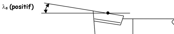
L'angle d'inclinaison  $\lambda_s$  négatif est utilisé pour des matériaux « durs » ou difficile à usiner, il permet d'obtenir un copeau en forme de spirale serrée. Il faut une machine puissante et rigide pour assurer un bon usinage.
