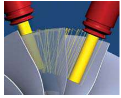
Ebauche par tréflage avec outils longs et minces
