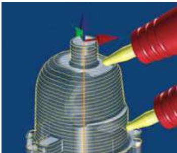
Orientation radiale de l'outil par rapport à l'axe Z
