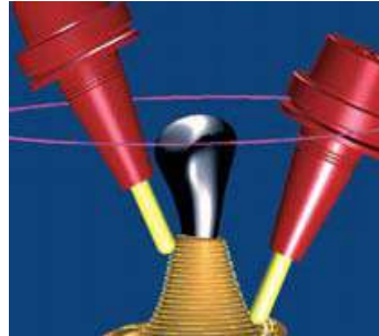
L'axe de l'outil passe localement par la courbe de guidage
