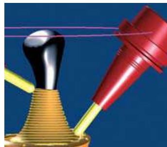
L'axe de l'outil passe toujours par la courbe de guidage
