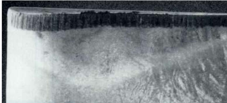
Figure 4 : vue de la face en dépouille et usure correspondante
