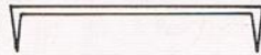
FIG. 9. - Clameau (sorte de cavalier en acier Ø 12 à Ø 16, destiné à relier les grumes).
