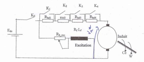
Démarrage rhéostatique d'un Moteur à Courant Continu
