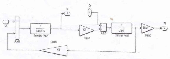
Schéma de Simulation (sous Simulink) d'un Moteur à Courant Continu
