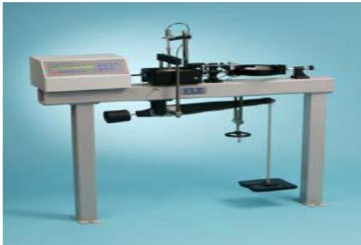
Figure 4-12: Appareil de cisaillement rectiligne
