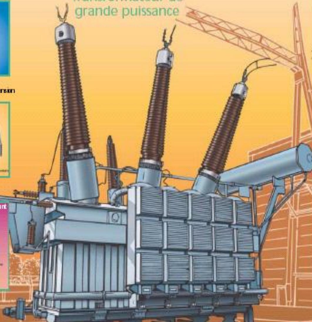
IL S'AGIT D'UN APPAREIL STATIQUE DESTINÉ À MODIFIER LA TENSION ÉLECTRIQUE.
