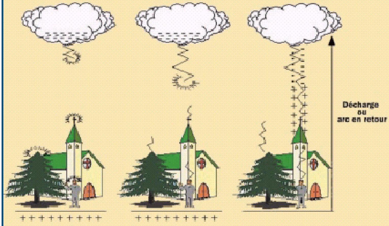
Un coup de foudre est composé de deux phases électriques. En premier lieu, il y a l'électricité électrostatique: déplacement de charges pour l'établissement du canal de foudre entre le nuage et le sol (phase permettant de comprendre pourquoi un objet non-conducteur peut être foudroyé). En deuxième lieu, il y a passage d'un courant électrique dans le canal ionisé.
