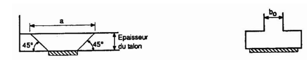
Dans ce dernier cas, l'attention est attirée sur le fait que l'adjonction d'un montant d'épaisseur égale à la largeur de l'appui permet d'augmenter la sécurité vis-à-vis de la bielle d'about.
