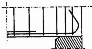
Dans les autres cas, et notamment dans celui très fréquent où les éléments de planchers reposent sur des appuis en béton (poutres, poteaux ou voiles), la portée à prendre en compte dans les calculs est mesurée entre nus des appuis.
