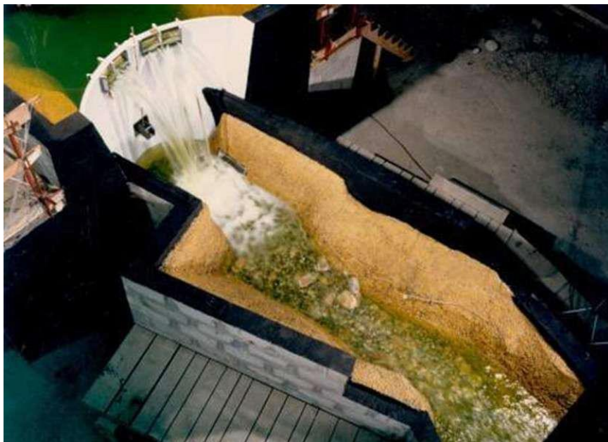
Figure 5.10: Etude sur modèle réduit de l'évacuateur de crue du barrage de Turkwel au Kenya
