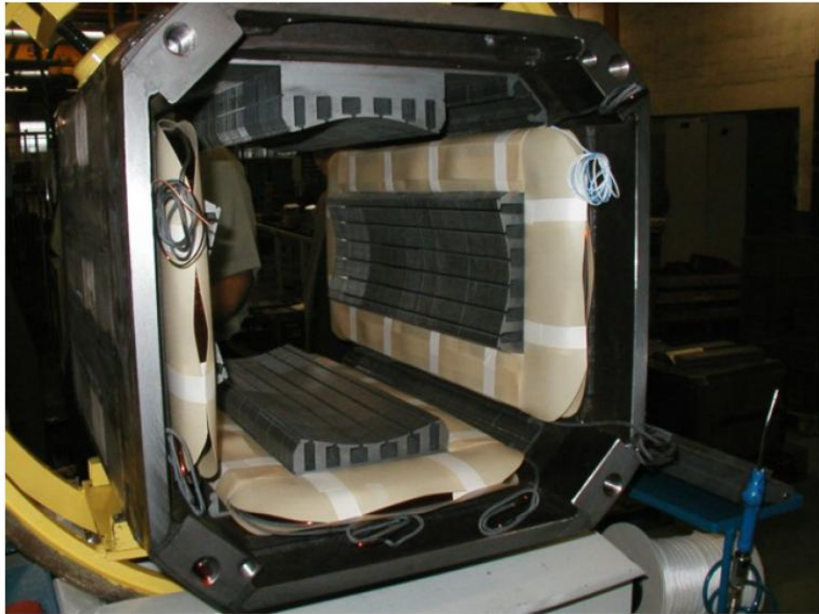
Fig 2.6 : Mise en place des bobines sur le circuit magnétique d'une machine à courant continu
