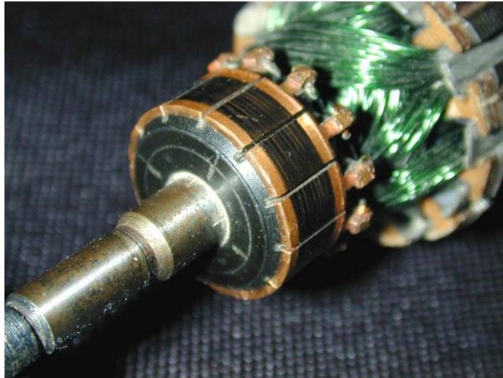
Fig 2.8a : Collecteur d'une machine à courant continu de faible puissance
