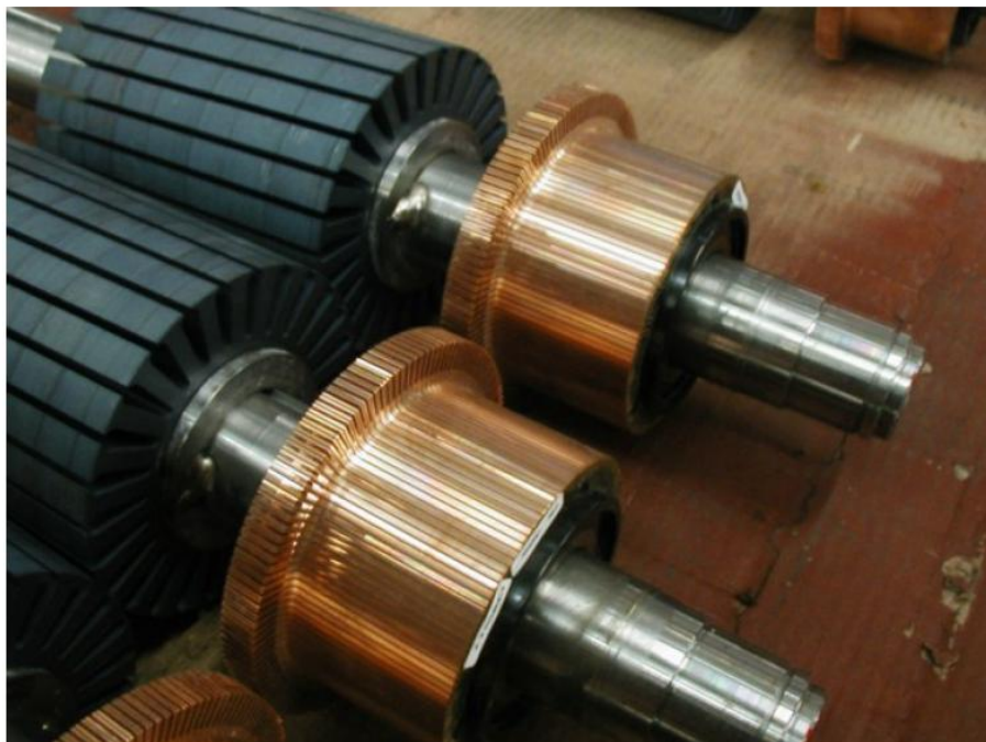
Fig 2.8b : Collecteur d'une machine à courant continu de forte puissance
