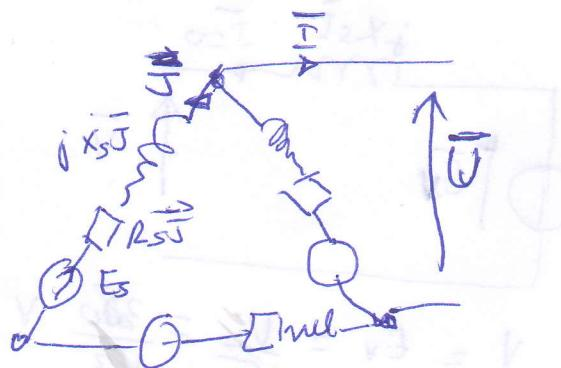
Schéma équivalent d'une phase
