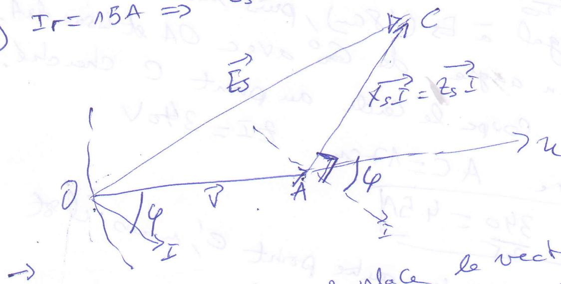
On peut donc mettre en place le vecteur AC dans la figure, de C comme centre, on tracer un arc de cercle de rayon égal à  $E_S$ , qui coupe l'axe des  $u$  en  $O$ . On mesurera  $OA = V \approx 264V$ .
