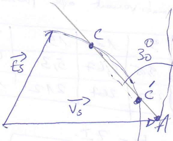
On peut mettre en place : les pôles D et A ( $OA = \frac{380}{20} = 19 \text{ cm}$ ), puis un cercle de centre O faisant un angle de  $60^\circ$  avec OA et issue de A, coupant le cercle au point C cherché. La droite coupe le cercle au point C  $ZI = 340 \text{ V}$
