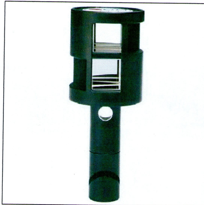
fig7 : exp d'équerre optique
