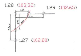
Entre le point 1.28 d'altitude (103.32) et le point 1.29 (102.65) la courbe 103 passe forcément entre ces points car 103.00 est compris entre 103.32 et 102.65 et on fait une interpolation linéaire pour trouver le point de passagede cette courbe. On calcule le dénivelée entre 1.28 et 1.29 103.32-102.65=0.67m
