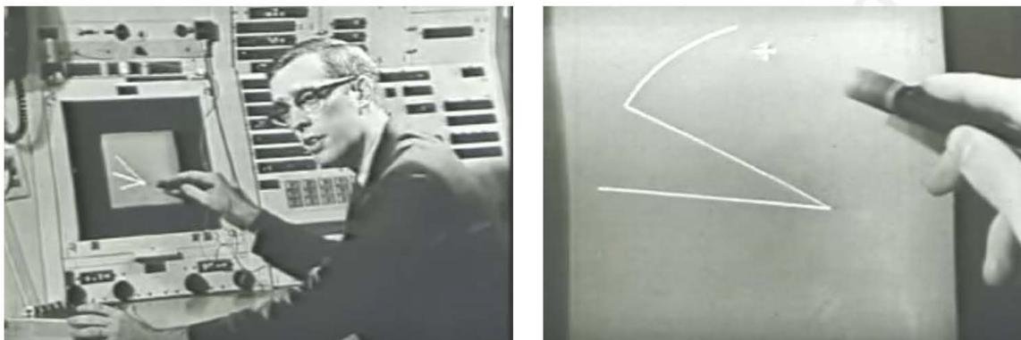
Fig. 5. Présentation de SKETCHPAD sur le Le TX-2 - Lincoln Laboratory du MIT - 1958.
