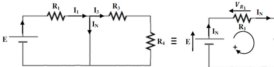
Les deux résistances  $R_3$  et  $R_4$  sont court-circuitée (car les deux résistances sont placées en série et leur résistance équivalente est branché en parallèle avec un fil conducteur de résistance nulle), elles ne sont donc traversées par aucun courant. Le schéma simplifié résultant donne le courant de Norton :  $\sum V = 0 \Rightarrow E - V_{R_1} = 0 \Rightarrow E - R_1 I_N = 0$
