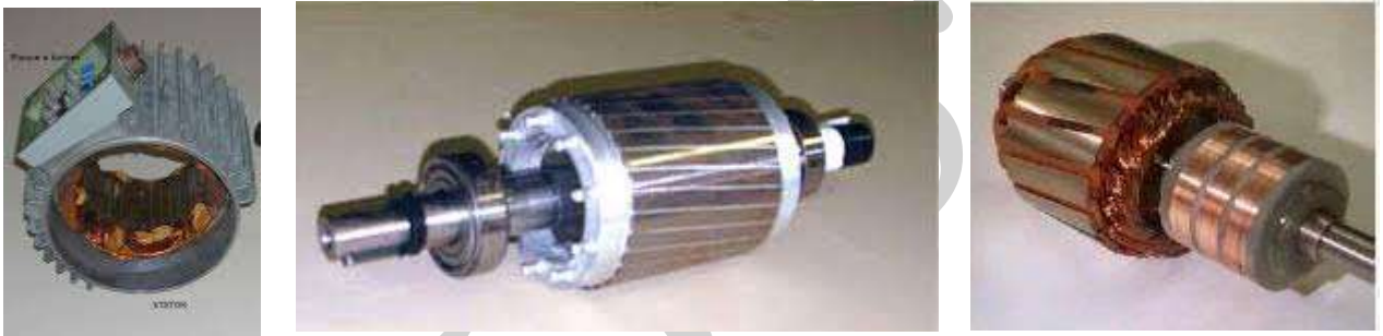
Fig. (2-1) : Constitution de la machine asynchrone
