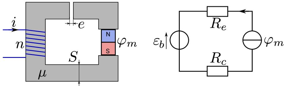
Figure 9: Circuit magnétique et son analogie électrique
