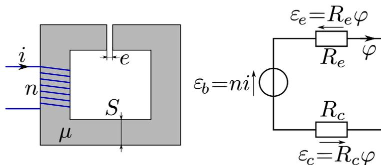
Figure 10: circuit magnétique avec bobine et entrefer et sa modélisation magnétique.
