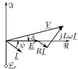
Le flux magnétique généré par une bobine du stator est directement proportionnel à  $\underline{I}$ , suivant  $\mathfrak{R}$  pour la bobine A qui sert de référence à  $\omega t = \theta = 0$ . Ainsi, le flux magnétique  $\underline{\varphi}_s$  généré par le stator est représenté par un vecteur proportionnel à  $\underline{I}$ .
