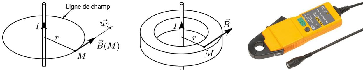
Le tube de champ guide les lignes de champs et les génératrices du tube sont tangentes au champ, si bien que le flux circulant dans le tube est constant pour toutes les sections.
