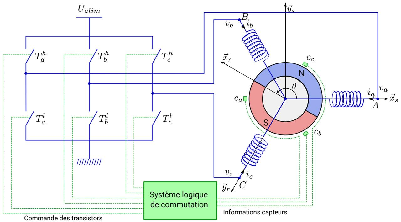
Figure 2: Fonctionnement de l'onduleur et du moteur brushless
