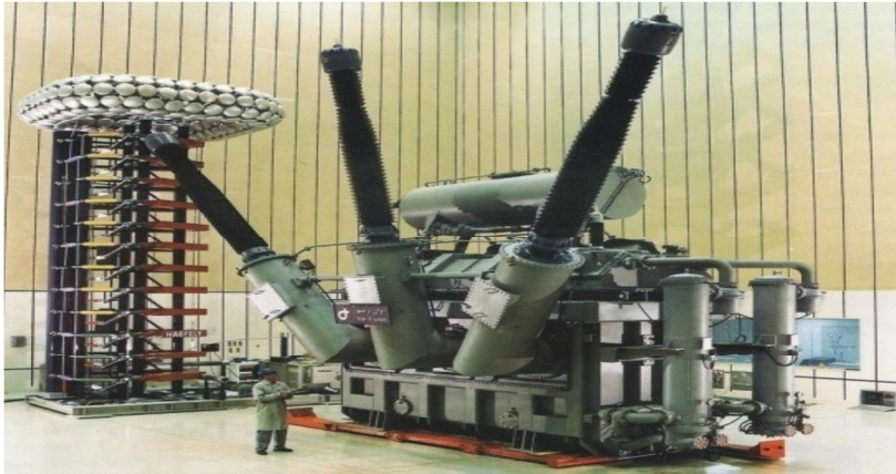
Figure II.5 – Transformateur de puissance
