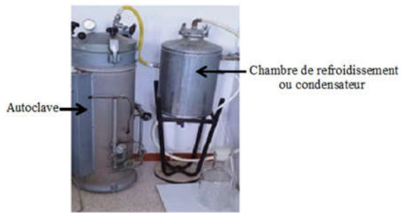
Figure 1: Dispositif d'extraction de l'huile essentielle de Thymus vulgaris
