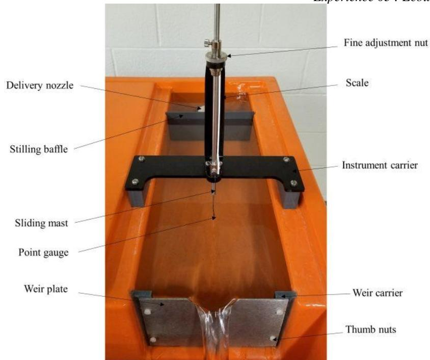
Figure 1 Banc hydraulique et dispositif de déversoir
