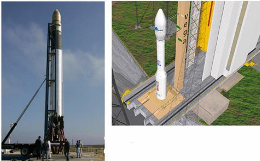
A droite, Fusée Vega sur son pas de tir : les trois premiers étages de ce lanceur sont à propergol solide © ESA A gauche, Lanceur Falcon I à propergol solide © SpaceX
