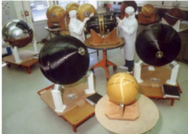
Sphères de stockage d'ergols © EADS
