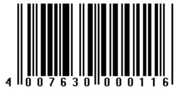
FIGURE 3.13: Exemple d'un code à barres EAN-13.
