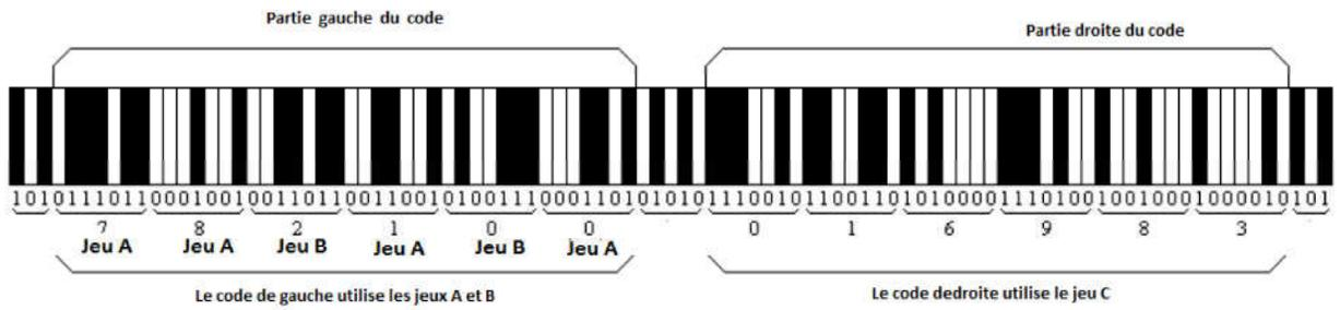
FIGURE 3.12: Codage 7 bits pour le code à barres EAN-13.
