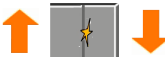
Faille en décrochement
