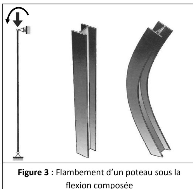
**Figure 3** : Flambement d'un poteau sous la flexion composée
