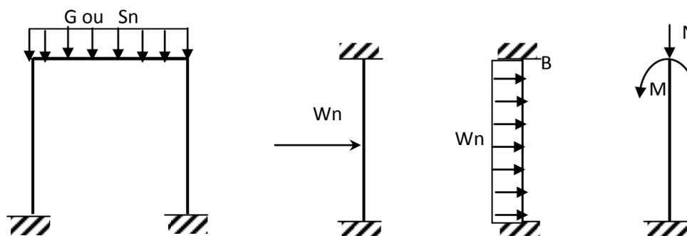
Figure 1 : poteaux sous la flexion composée
